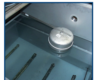
Prozesswassertank mit Heizung und automatischer Füllstandsregelung
