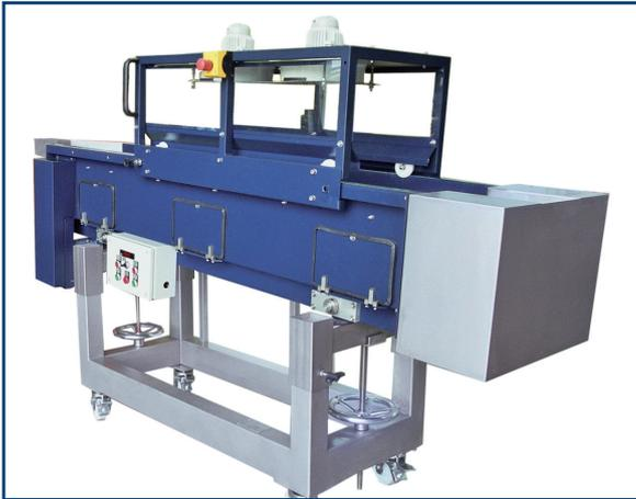
**Variante:** Kühlung durch Luftströmung (Ventilatoren drehzahlgesteuert)
