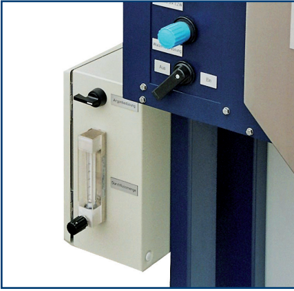
Schneidraumkühlung mit Volumendurchflussanzeige der Kühlluft
