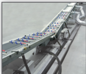
Stranggranulierung mit automatischer Strangzuführung
