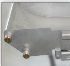
Durchdachte Details – runder Anfahrkopf verhindert Ablagerung von Polymersträngen
