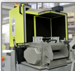
Einfacher Zugang zum Schneidkopf für Reinigungs- oder Wartungsarbeiten
