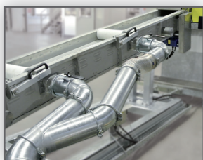
Integrierte Strangabsaugung durch das Band
