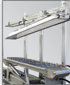
Absaugung über der Strangkühlrutsche
