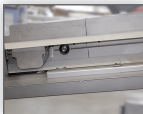
Schneller, werkzeugloser Zugang zum Strangtransportband zur Wartung und Reinigung
