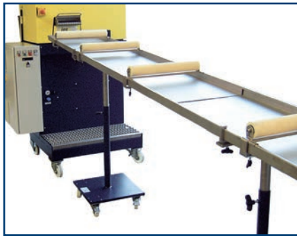
Strangzuführung von Strangkühlwanne zum Stranggranulator
