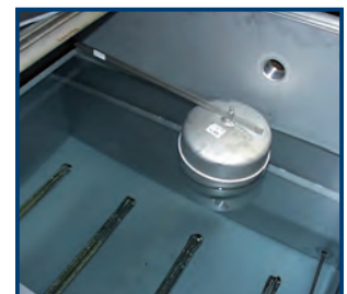
Prozesswassertank mit Heizung und automatischer Füllstandsregelung
