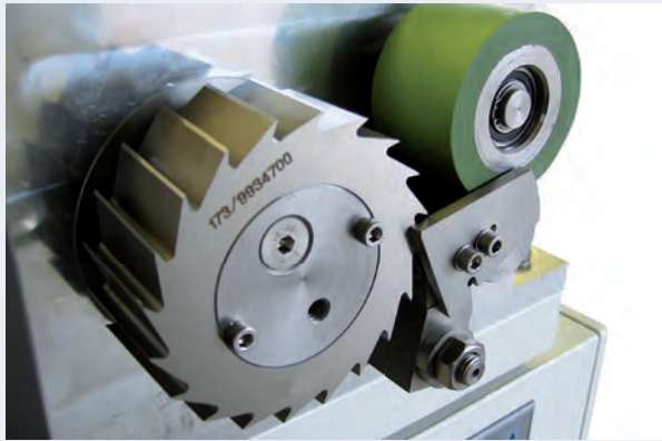
Einseitige Lagerung des Schneid- und Einzugwerkes
