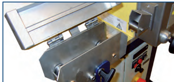
Option: ips-SG-E 30 Kombi Integrierte Strangentwässerung durch Absaugen
