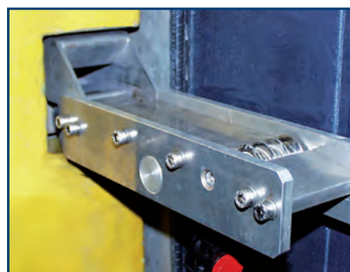
Einzugshilfe für weiche, elastische Polymerstränge
