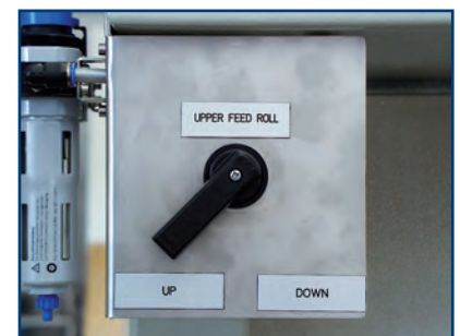
Pneumatische Anpressung der oberen Einzugswalze
