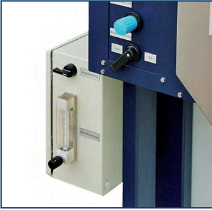
Schneidraumkühlung mit Volumendurchflussanzeige der Kühlluft
