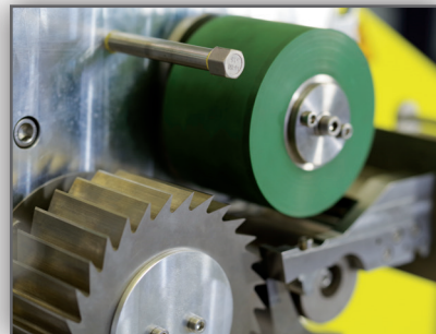
Schneidraumkühlung mittels Druckluft
