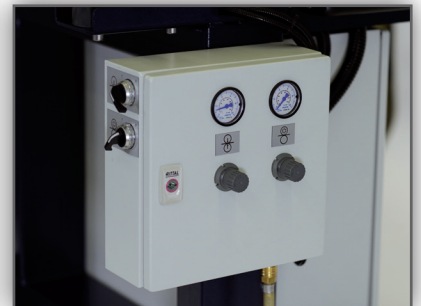
Standard: Pneumatische Anpressung der oberen Einzugswalze
