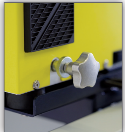
Standard: Einstellung des Einzugswalzenspaltes während des Betriebs
