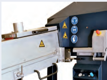
Einfache Verschiebung des Strangtransportbandes für Reinigungs- oder Wartungsarbeiten
