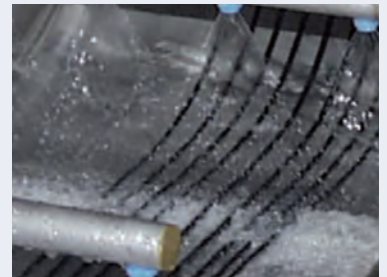
Durchdachte Details – runder Anfahrkopf verhindert Ablagerung von Polymersträngen
