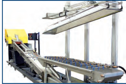
Absaugung über der Strangkühlrutsche
