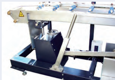
Besonders einfache und ergonomische Bedienung. Höheneinstellung des Anfahrkopfes zur Anpassung an die Prozessgegebenheiten
