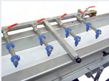
Einfach auszutauschende Prozesswassersprühdüsen
