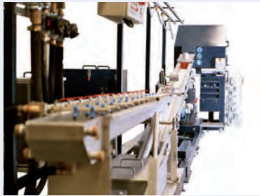
Stranggranulierung mit automatischer Strangzuführung
