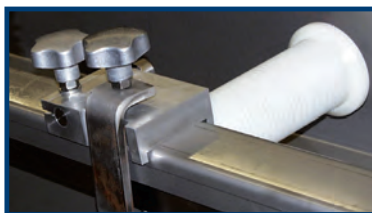
Einseitige Lagerung der Strangführungsrollen für optimale Zugänglichkeit
